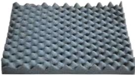
Mousse en polyuréthane complexée avec une mousse PAE à base de polyether (alvéole de 30 mm et talon de 20 mm). Ce matériau, d'une densité de 29 kg/m<sup>3</sup> a une excellente capacité d'absorption. Cette mousse diminue ainsi la propagation de l'onde sonore (dans un volume donné).
